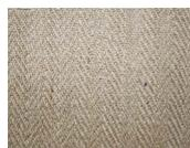
Jutegurten sind schmale, leinwandbindige Gewebestreifen aus Jutegarnen für Sitz- bzw. Rückenpolsterungen. Ausschlaggebend für die Qualität ist die Art der verwendeten Zwirne für die Kette (zwei- oder dreifach) und die Fadendichte.
